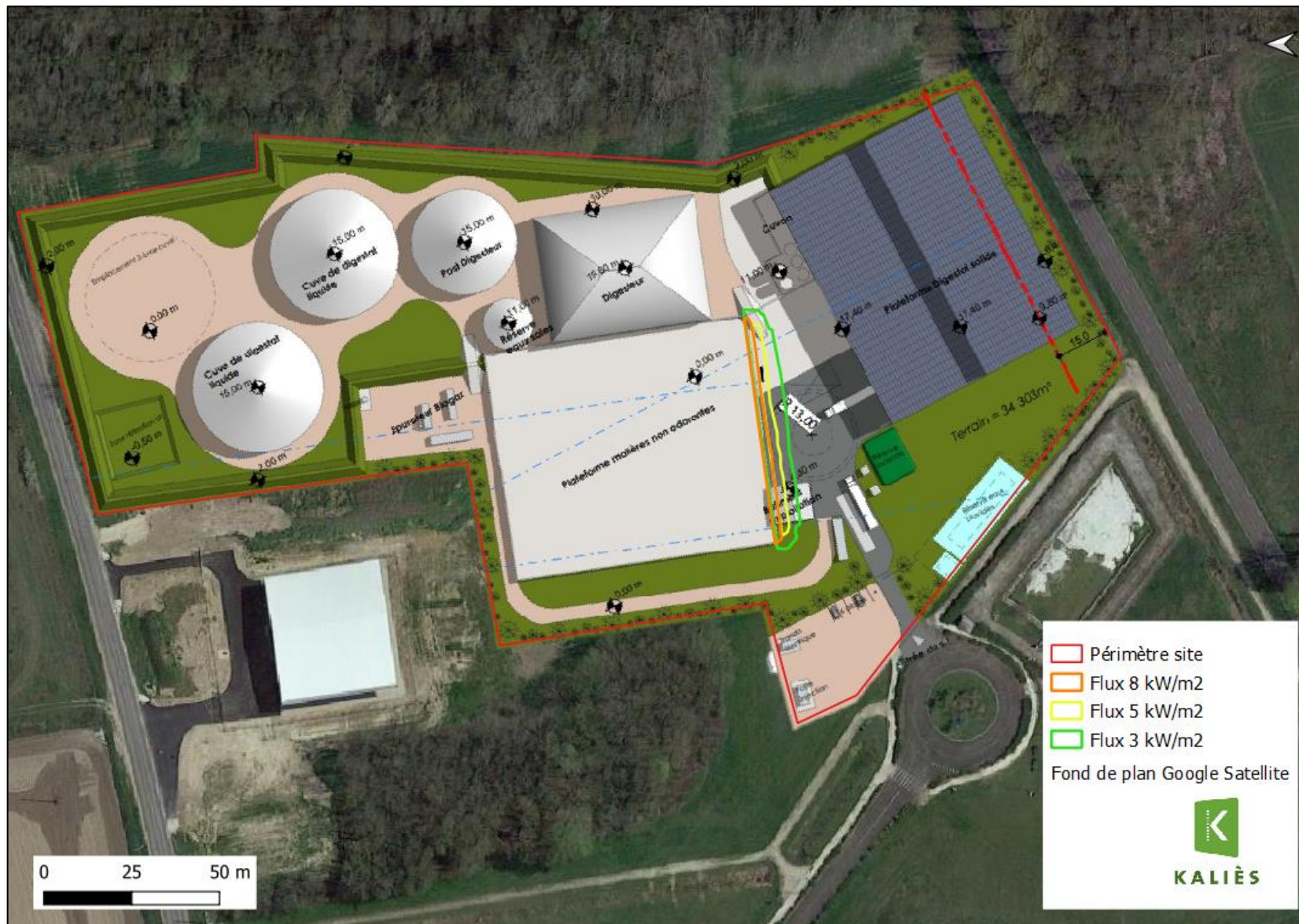
Figure 4. Flux thermiques en cas d'incendie de la plateforme de stockages des intrants non odorants
