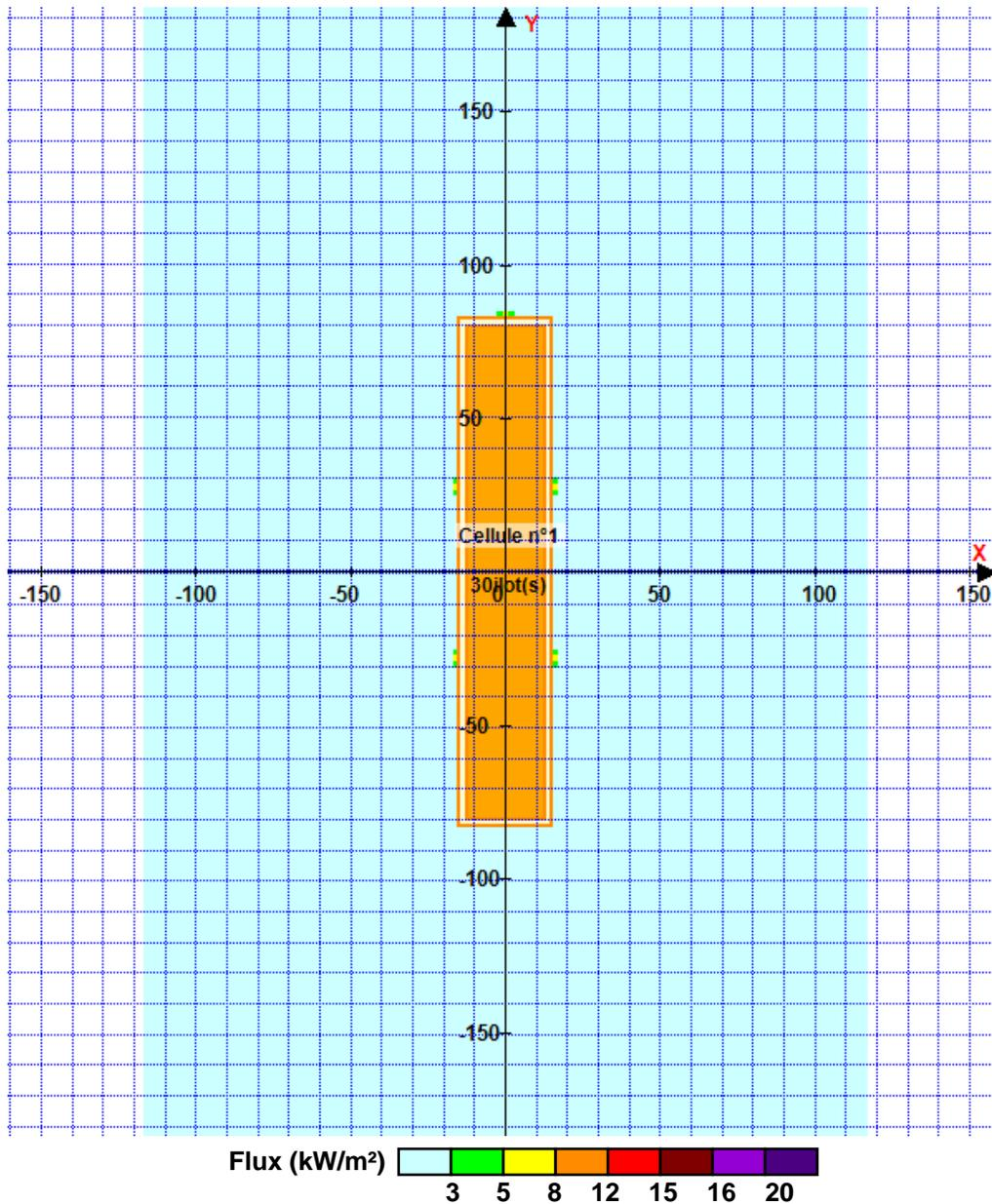
Pour information : Dans l'environnement proche de la flamme, le transfert convectif de chaleur ne peut être négligé. Il est donc préconisé pour de faibles distances d'effets comprises entre 1 et 5 m de retenir une distance d'effets de 5 m et pour celles comprises entre 6 m et 10 m de retenir 10 m.
