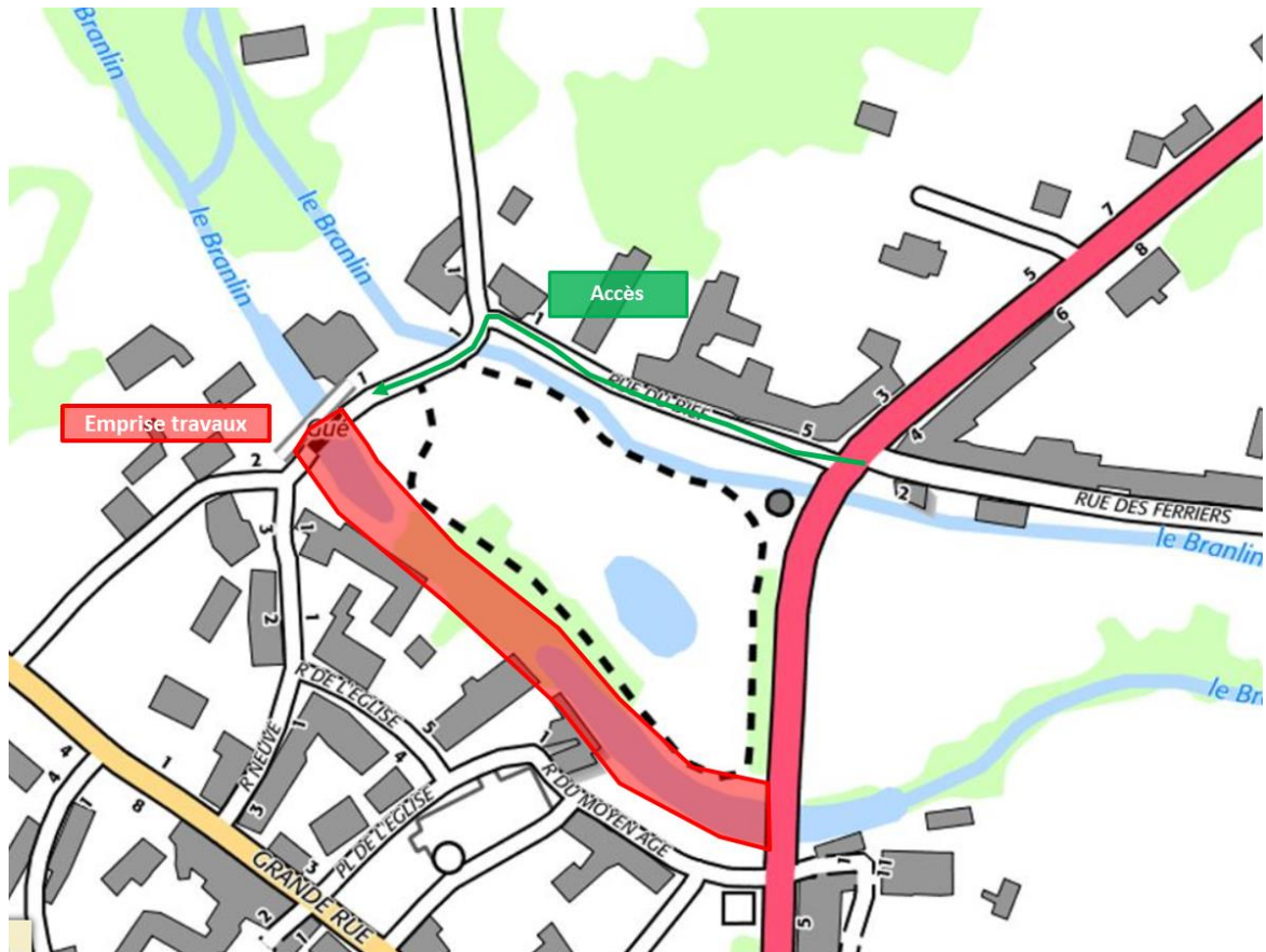
Fig. 48. Modalités d'accès au chantier sur la traversée hydraulique du Bourg
