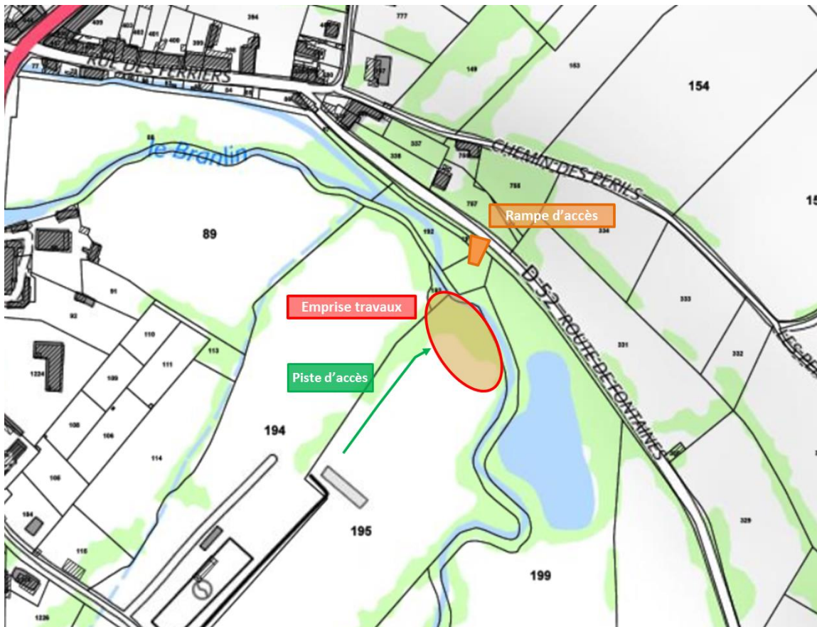
Fig. 47. Modalités d'accès au chantier sur l'ouvrage amont
