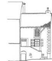
Maison vigneronne à Toumus : implantation contrainte par la mitoyenneté, maison modeste et compacte, cave semi-enterrée, galerie sur cave, habitation à l'étage, toiture deux pans en tuiles maconnaises, chaînage d'angle en pierres taillées apparentes, voûte sur une seule fenêtre, compacté du volume - source : L'architecture rurale française, La Bourgogne, BUCAILLE ET LEVI-STRAUSS
