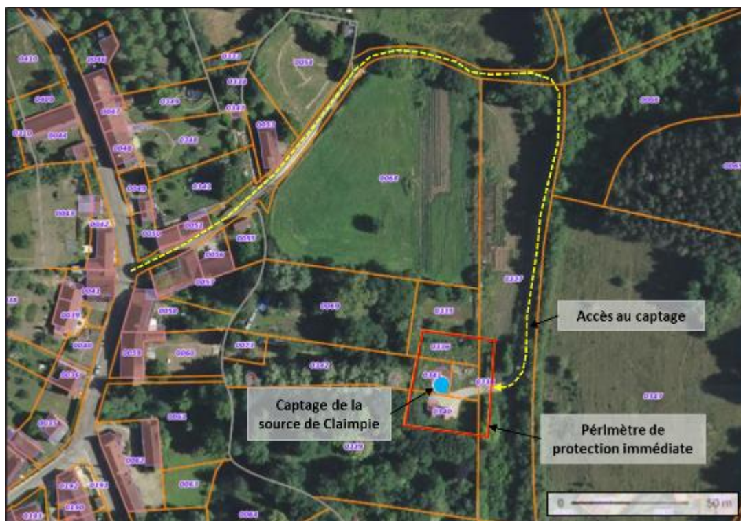
Figure 13 : limites du périmètre de protection immédiate du captage de la source de la Claimpie
