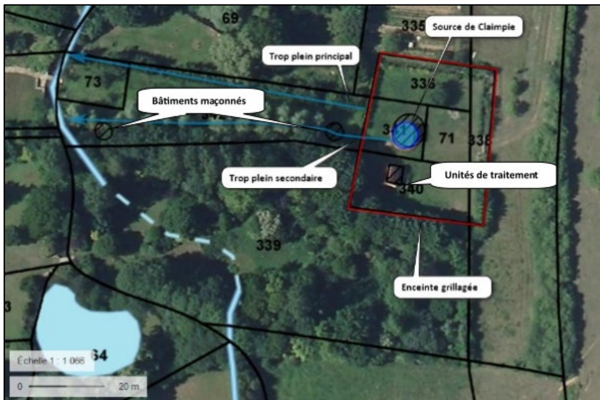
Figure 9 : Captage de La Claimpie Vue aérienne 2018, réseau hydrographique et cadastre, Géoportail
