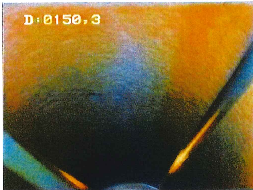
34- Trou nu – formation carbonatée massive
