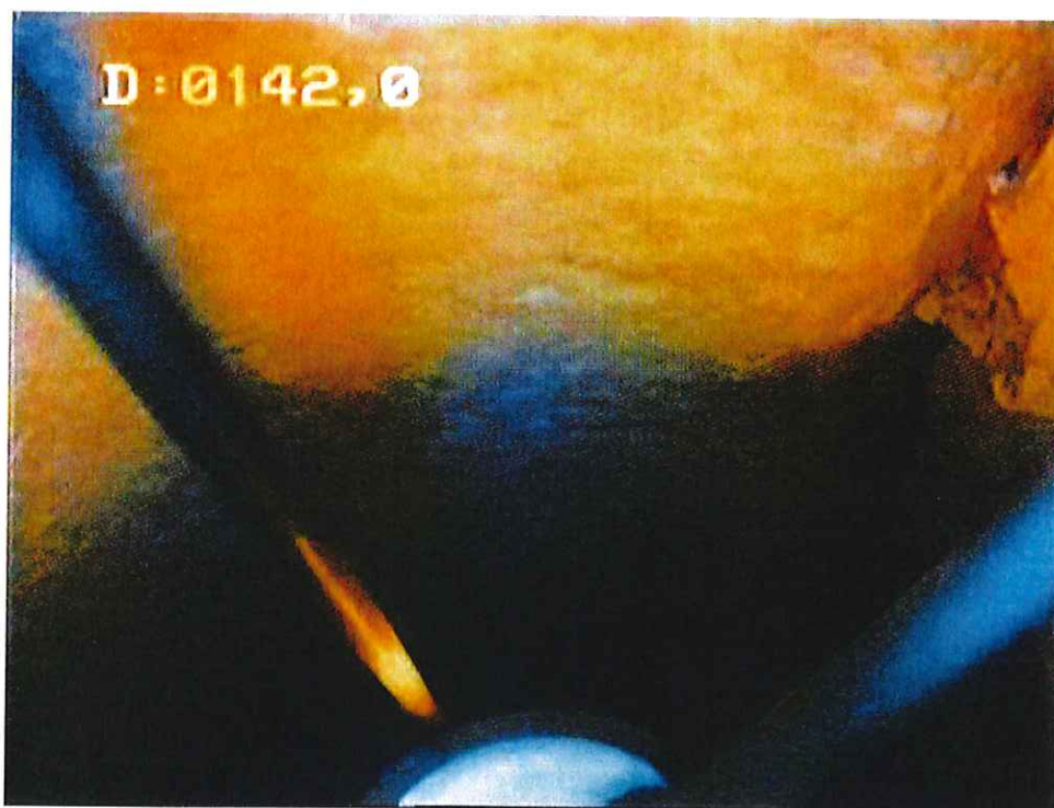
23- Trou nu – formation carbonatée massive, fracturation verticale
