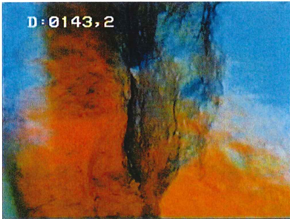
25- Trou nu – formation carbonatée massive, fracturation verticale
