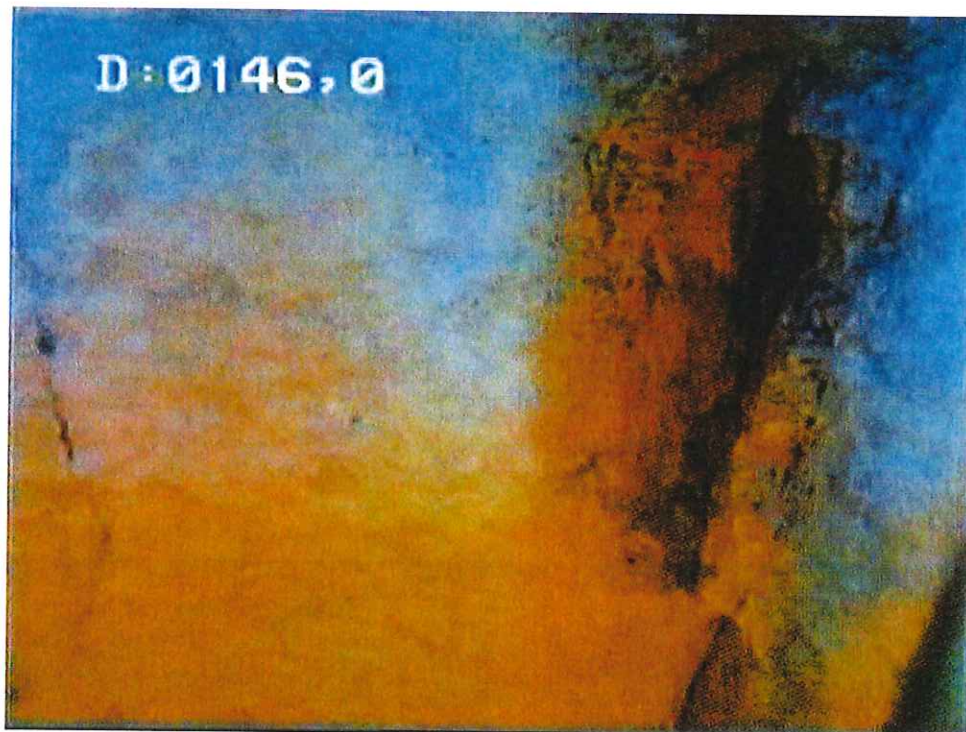
28- Trou nu – formation carbonatée massive, fracturation verticale
