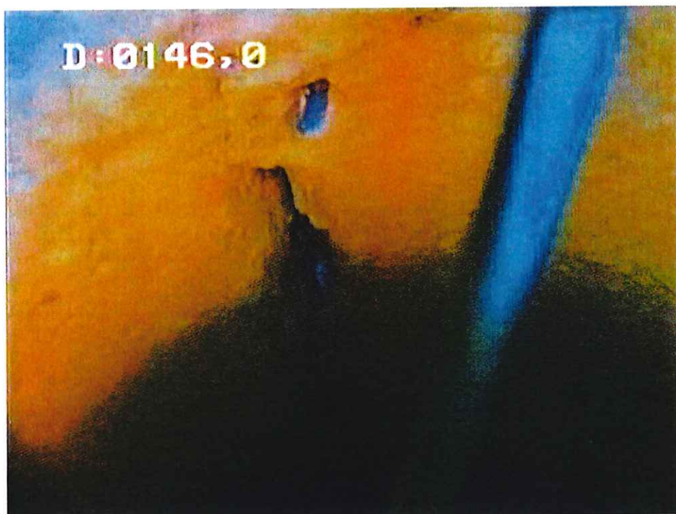
29- Trou nu – formation carbonatée massive, fracturation
