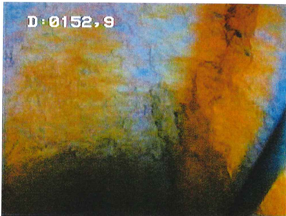
36- Trou nu – formation carbonatée massive, fracturation
