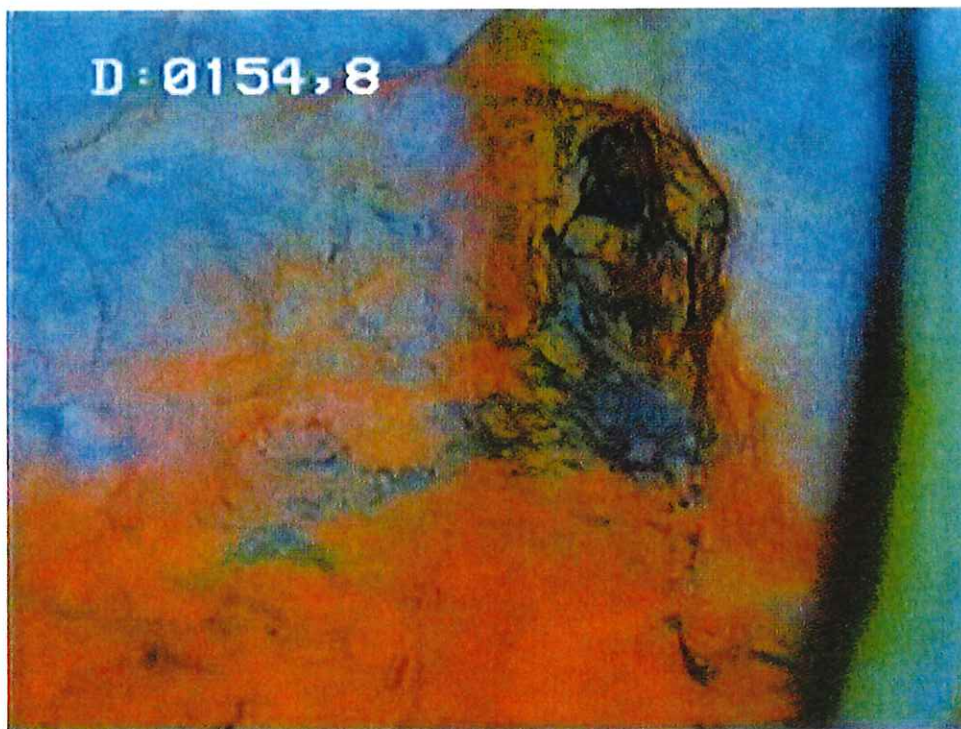
37- Trou nu – formation carbonatée massive, fracturation
