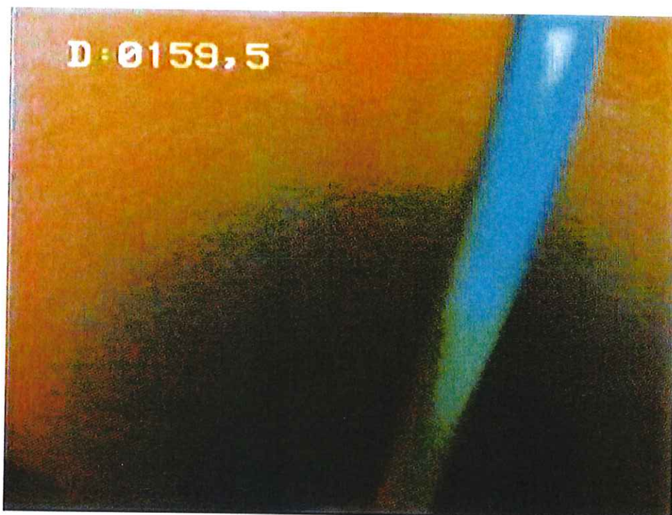
43- Trou nu – formation carbonatée massive
