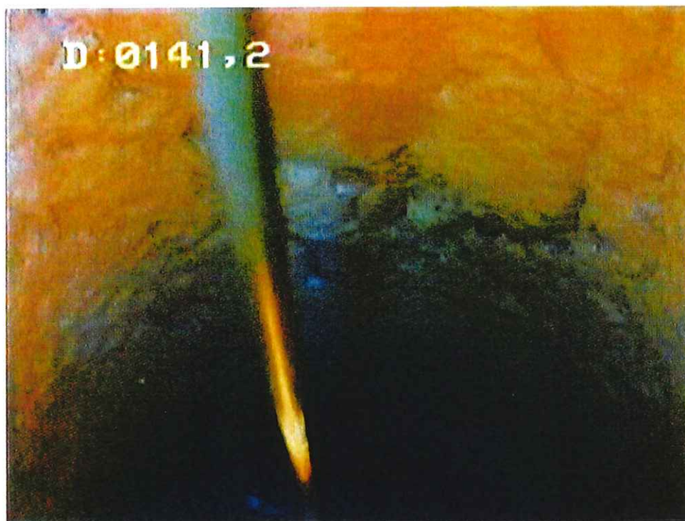
21- Trou nu – formation carbonatée massive
