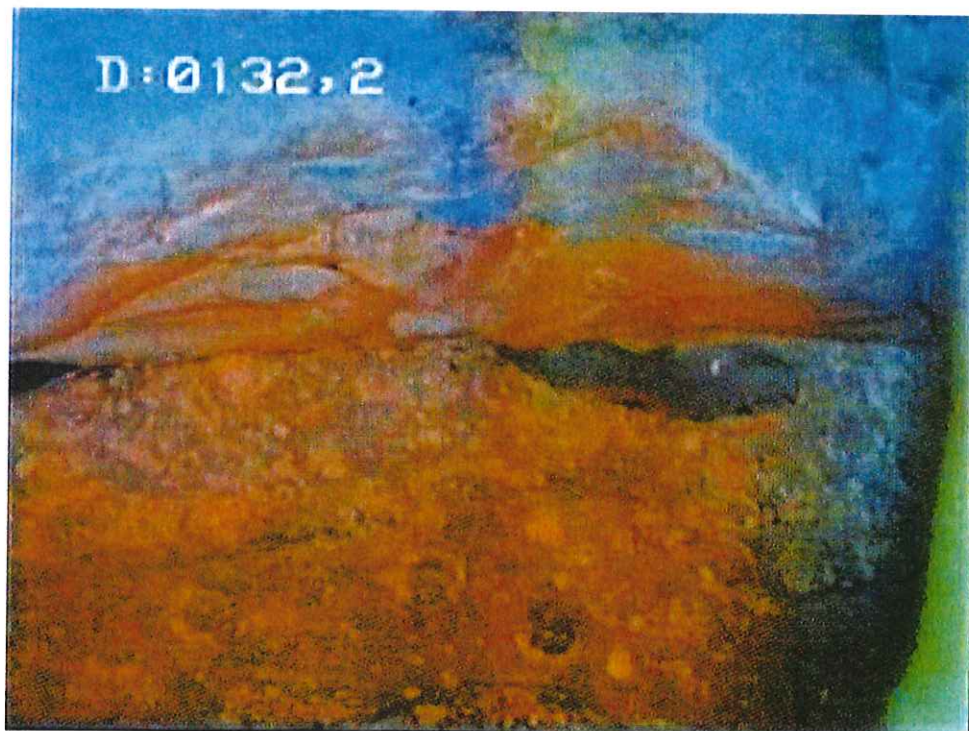
16- Trou nu – contact ciment/formation carbonatée aquifère
