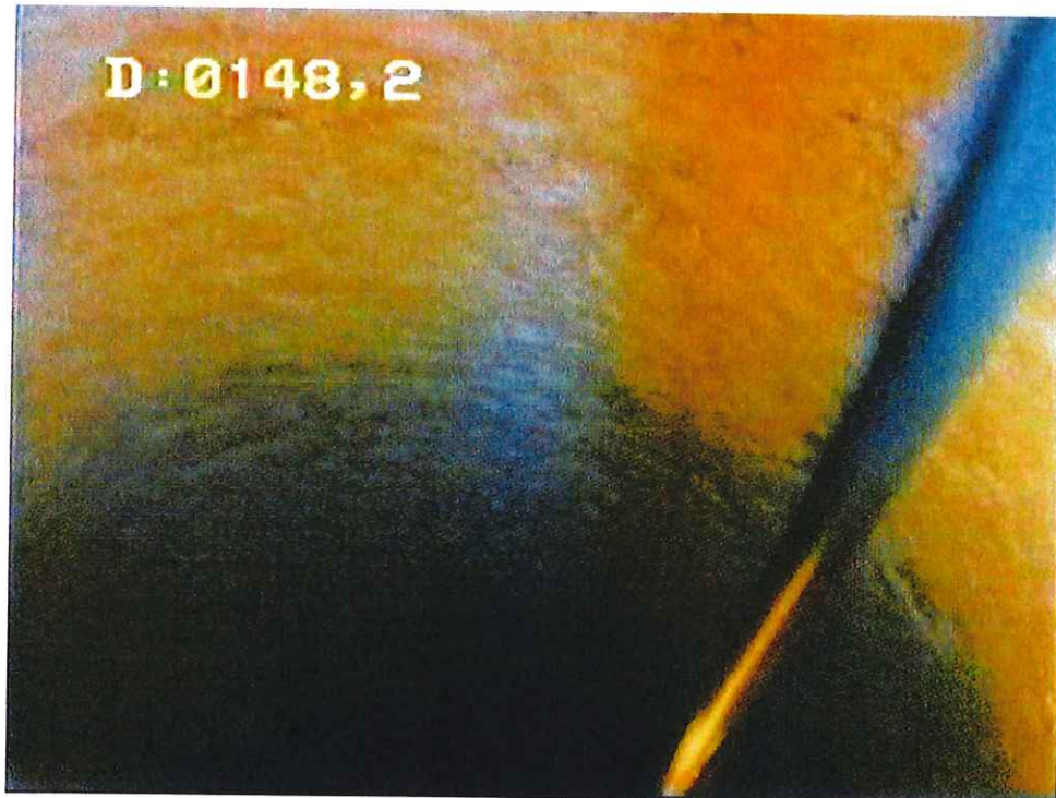
32- Trou nu – formation carbonatée massive
