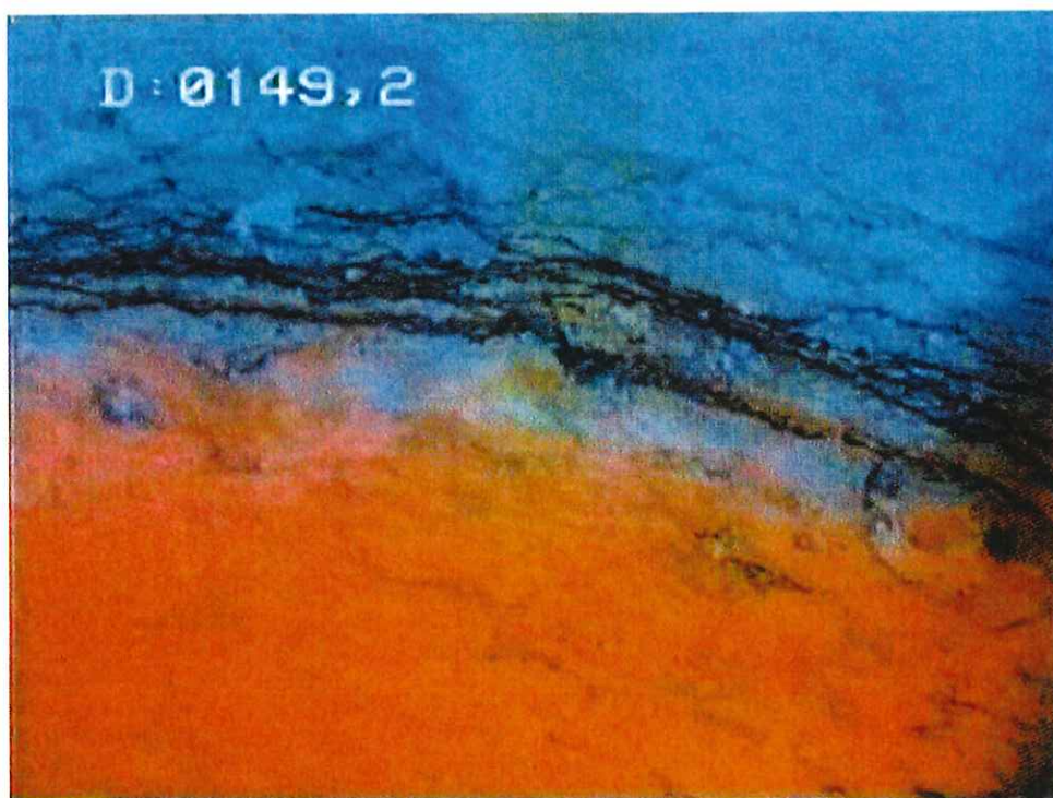
33- Trou nu – formation carbonatée massive
