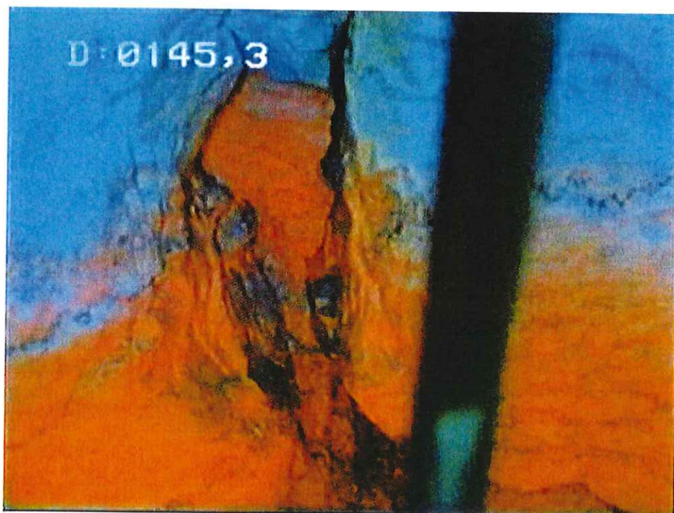
27- Trou nu – formation carbonatée massive, fracturation verticale
