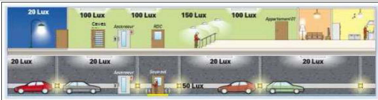
Valeurs d'éclairage des parties communes
